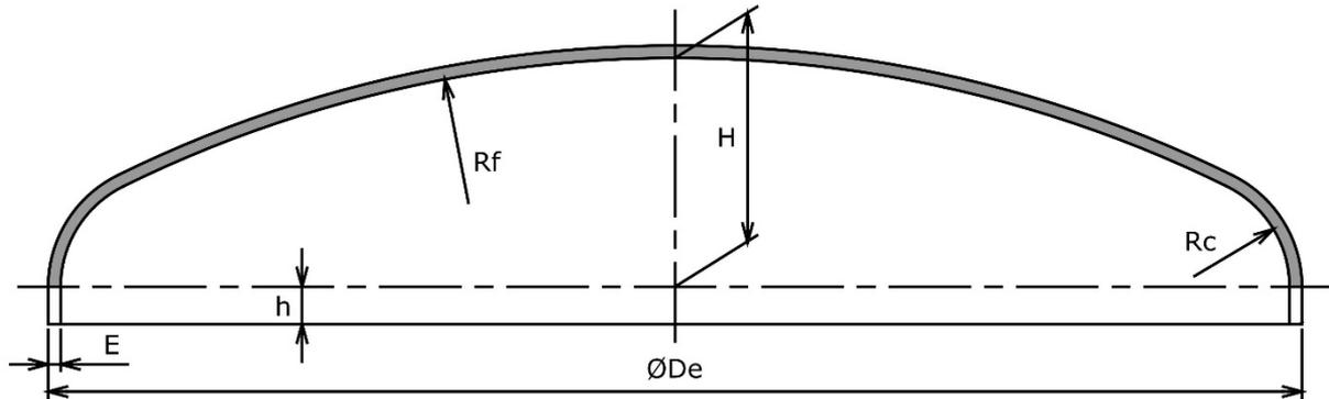
Le fond bombé « grand rayon de carre » dit GRC est déterminé par un rayon intérieur de la calotte sphérique égal au diamètre extérieur du fond et un rayon de carre au dixième de ce même diamètre. Les fonds GRC sont spécialement adaptés pour les appareils sous pression.
